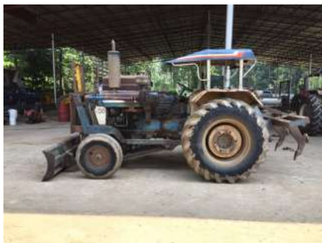
ภาพที่ 2.1 รถแทรกเตอร์ต่อพ่วงริปเปอร์เพื่อระเบิดดินดาน ที่มา: จากการสำรวจ
