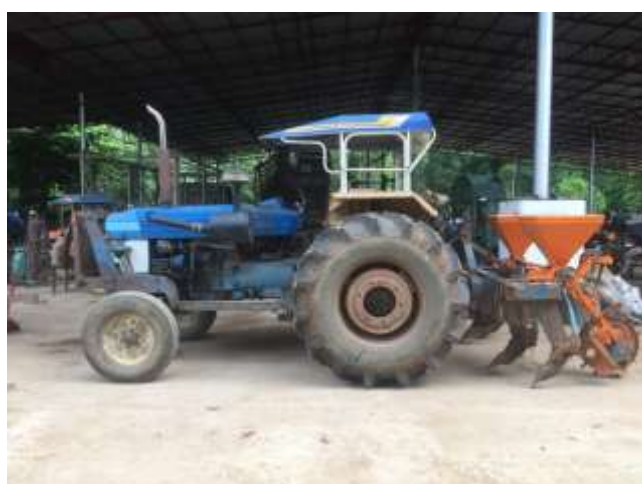
ภาพที่ 2.9 รถแทรกเตอร์ต่อพ่วงรีปเปอร์ใส่ปุ๋ย
