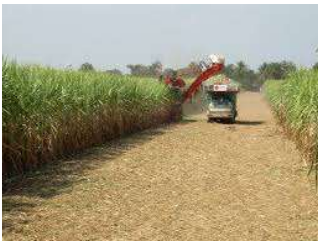
ภาพที่ 2.11 การตัดอ้อยด้วยรถตัดและการบรรทุก
