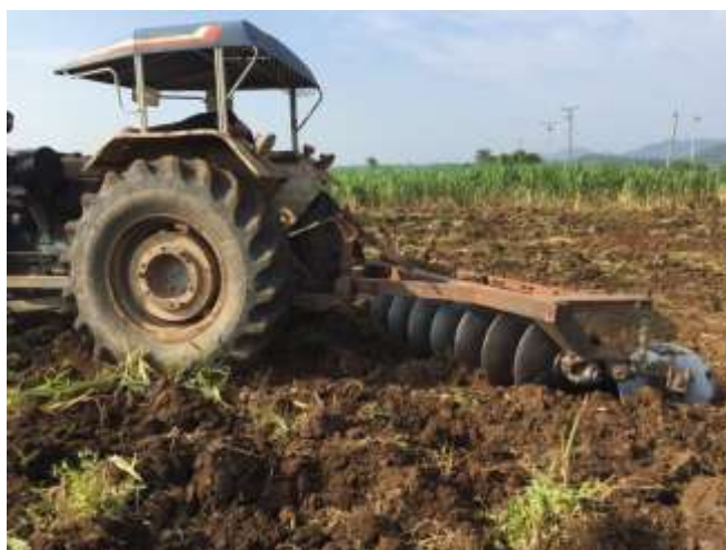
ภาพที่ 2.3 รถแทรกเตอร์ต่อพ่วงผานพรวน 7 ใบผานเพื่อไถพรวน ที่มา: จากการสำรวจ
