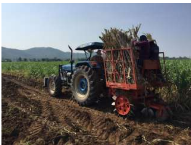
ภาพที่ 2.4 รถแทรกเตอร์ต่อพ่วงเครื่องปลุกอ้อย
