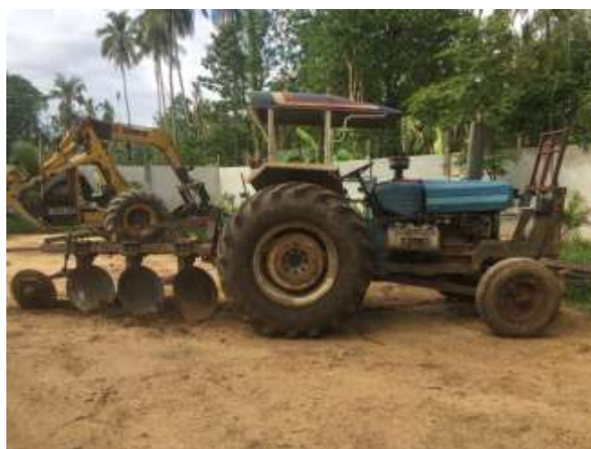
ภาพที่ 2.2 รถแทรกเตอร์ต่อพ่วงพานบุกเบิก 3 ใบผานเพื่อไถตะ ที่มา: จากการสำรวจ
