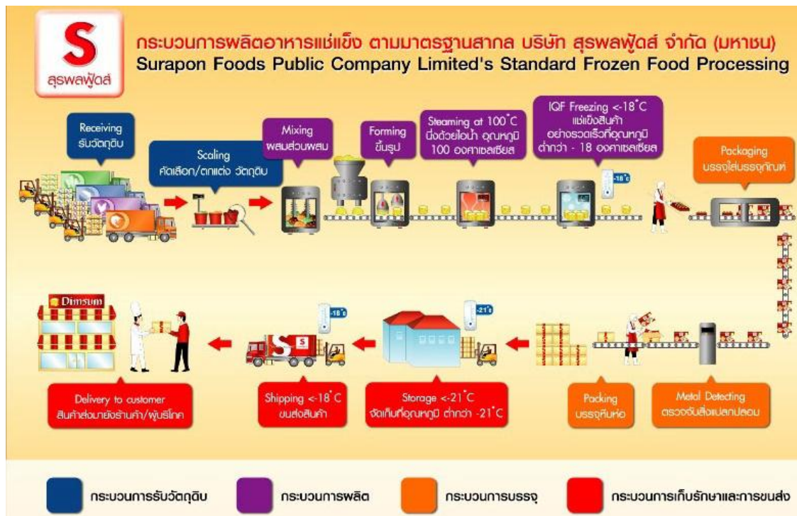
ภาพที่ 3 กระบวนการผลิตอาหารแช่แข็ง ตามมาตรฐานสากล บริษัท สุรพลฟู๊ดส์ จำกัด (มหาชน) ที่มา: สุรพลฟู๊ดส์ (2561)
